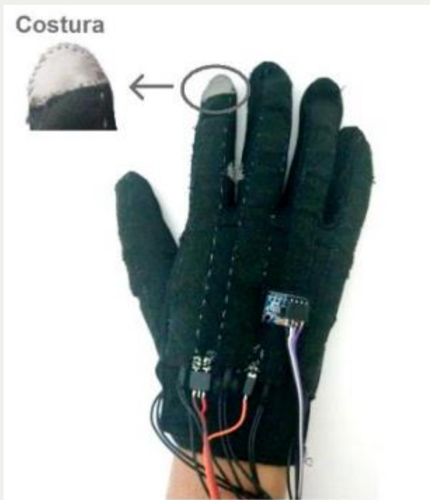
Figura 4.5 – Luva instrumentalizada. Fonte: Dias (2020).
